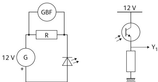
La diode laser Jeulin est alimentée par un générateur de fem  $E = 12$  V. (À prévoir en plus dans la liste du matériel si on utilise cette diode laser). Il faut introduire en série, entre la diode et le générateur, une résistance d'une centaine d'ohms environ (une résistance radio de  $120\ \Omega$  convient très bien).
