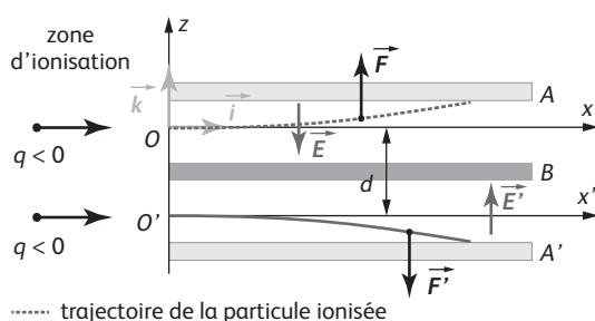
Entre les plaques A et B la particule est déviée vers A donc la force  $F$  est orientée de B vers A. La charge  $q$  portée par la particule étant négative, on en déduit d'après la relation  $F = qE$  que le champ  $E$  est orienté de A vers B comme indiqué sur la figure, ainsi que les signes positif de la plaque A et négatif de la plaque B.
