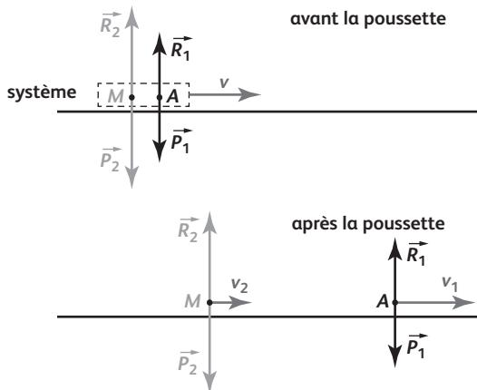
D'après le principe d'inertie, le système étant soumis à des forces qui se compensent, il est isolé: la quantité de mouvement du système se conserve.
