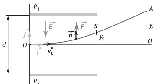
Dans le champ électrique, l'électron est soumis à une force électrique  $\vec{F} = -e\vec{E}$ .
