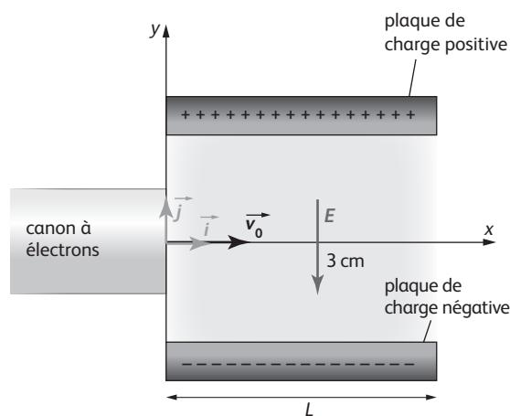
b. D'après la loi de Coulomb, des particules de charges opposées s'attirent. Le faisceau d'électrons étant attiré par la plaque chargée positivement, c'est que les électrons sont porteurs d'une charge négative.
