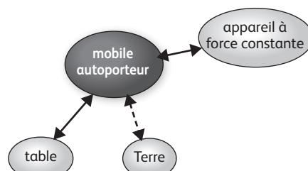
**b.** L'interaction entre la table et le mobile se fait sans frottement (mobile auto porteur), la force  $\vec{R}$  exercée par la table sur le mobile est alors perpendiculaire au plan de la table, elle est donc verticale. L'ensemble des forces a une direction horizontale (mouvement rectiligne du point A), la force  $\vec{R}$  exercée par la table sur le mobile s'oppose donc au poids  $\vec{P}$  et compense celui ci, soit :
